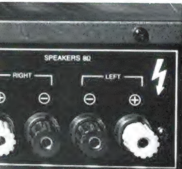
De PA-5030 is van een rijke hoeveelheid aansluitingen voorzien. De aansluitbus-sen zijn verguld.
